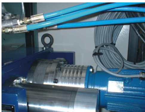
Рис. 5.5а: Example of bearing reducer's cooling / Пример охлаждения редуктора
